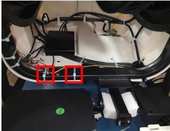
A.cut cable tie,disconnect the terminal
