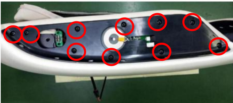
M. remove the screws
