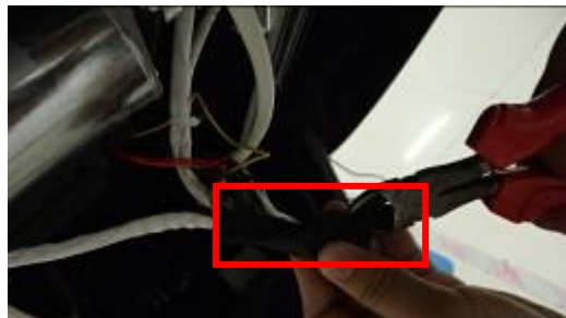
机芯上的电机电源及信号线 Disconnect moto wire and gear
