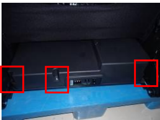
中心盒上前盖上的 3 枚螺丝 the 3 screws fixing front upper cover for PCB box
