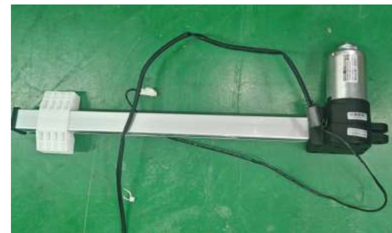
6.Remove the flat push rod
