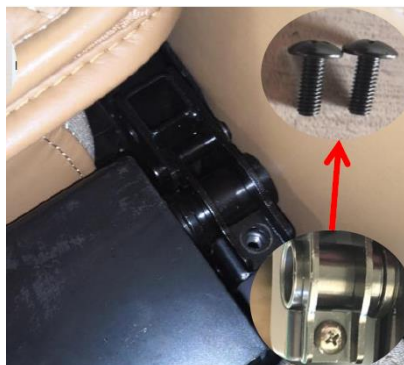
E、 Fastening gland screws
