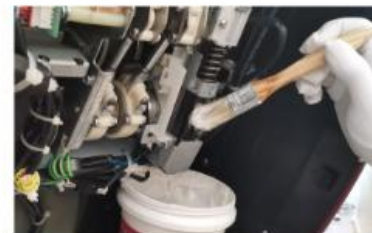
11、伸缩机构打固态润滑油
