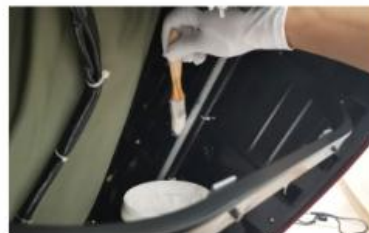
10、靠背导轨打固态润滑油
