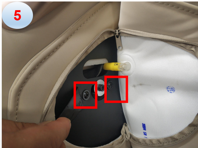
e. remove 2 screws
