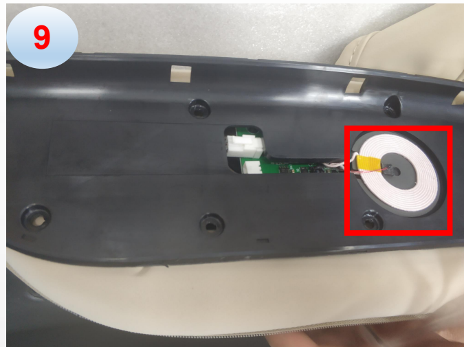
k. Tear off the magnetic ring
