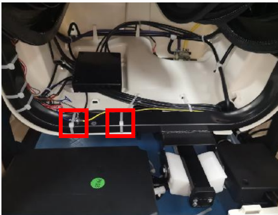
A.cut cable tie,disconnect the terminal
