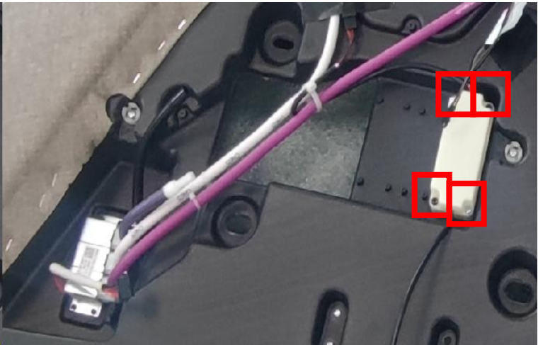
A. remove 4 screws
