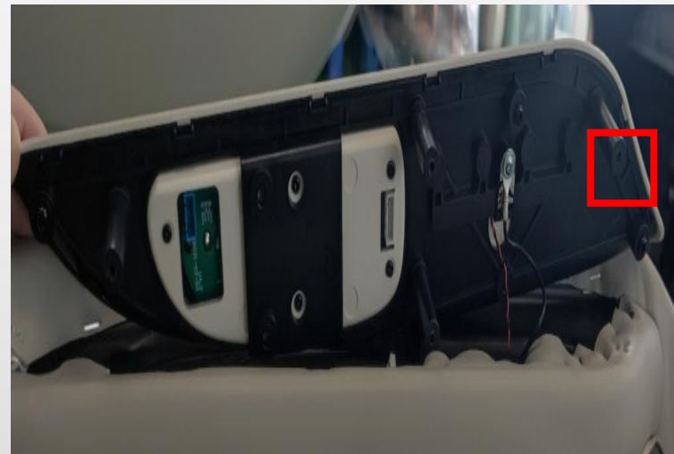
N. remove 1 screws
