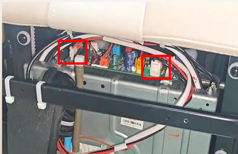
D.remove the terminal.
