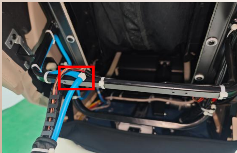
D.remove the terminal.
