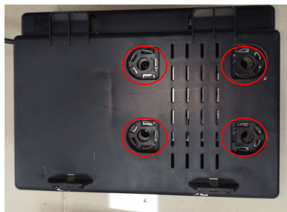
E. 取下固定气泵4颗螺丝
