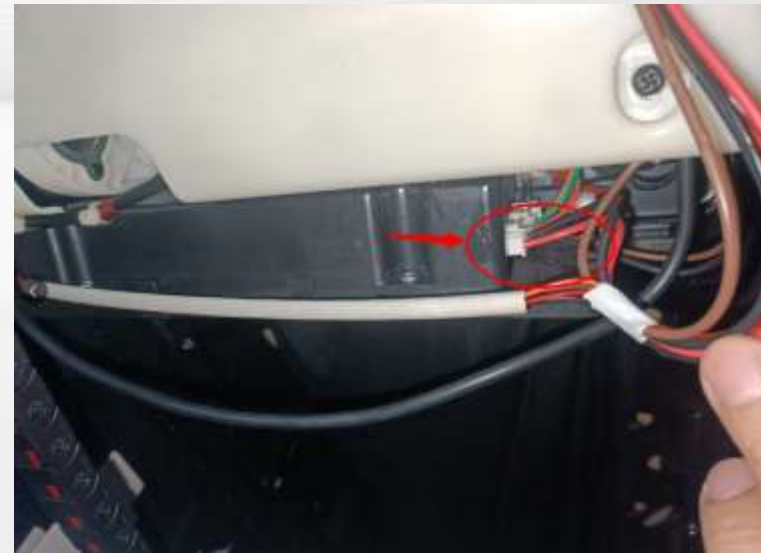
4.断开端子 Disconnect the terminal.
