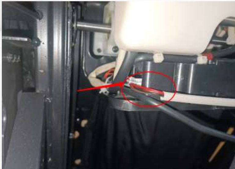
3.断开端子 Disconnect the terminal.
