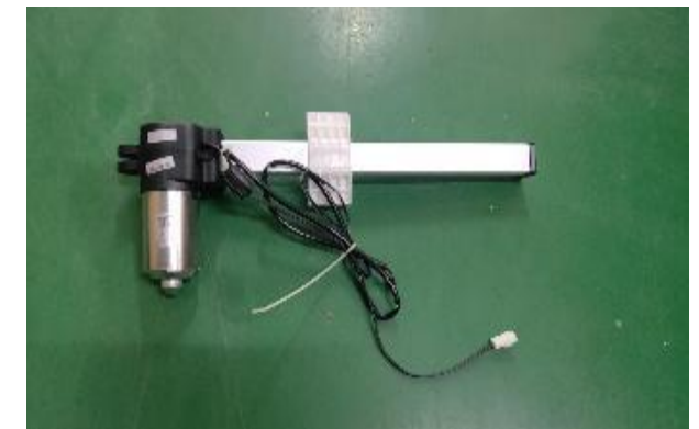
F. remove backrest actuator
