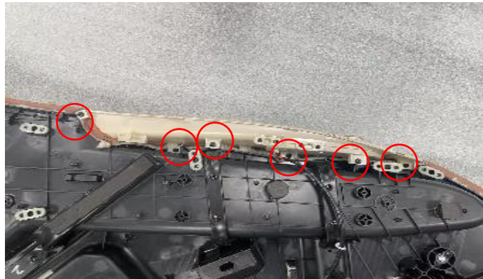
E. remove 6 screws
