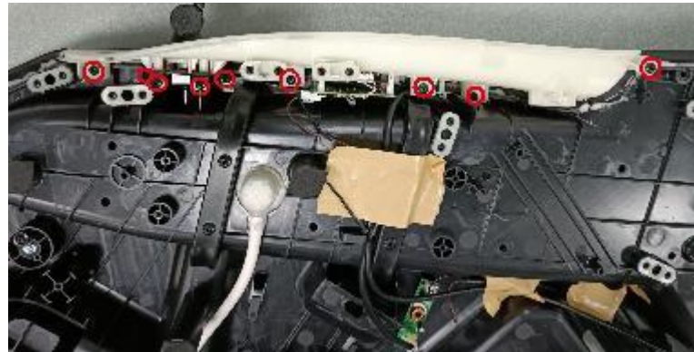
E. Remove 9 screws
