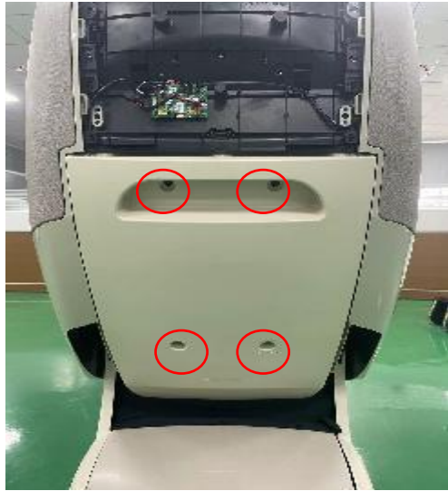
A. remove 4 screws
