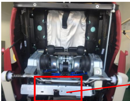
机取固定靠背总线的螺丝 remove the screw
