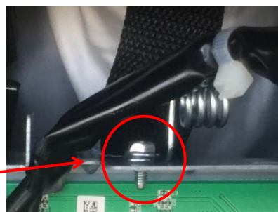
机取固定靠背总线的螺丝 remove the screw
