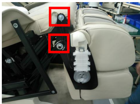
每边各 2 颗螺母 2 nuts on each side
