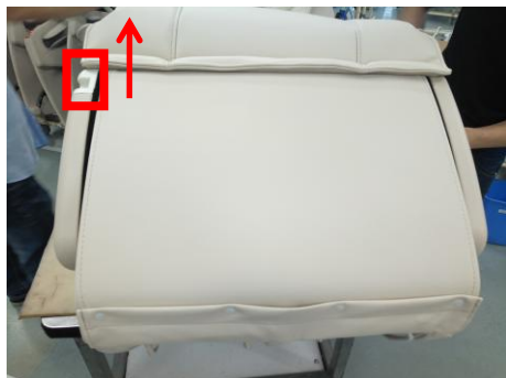
开关位置 Switch position
