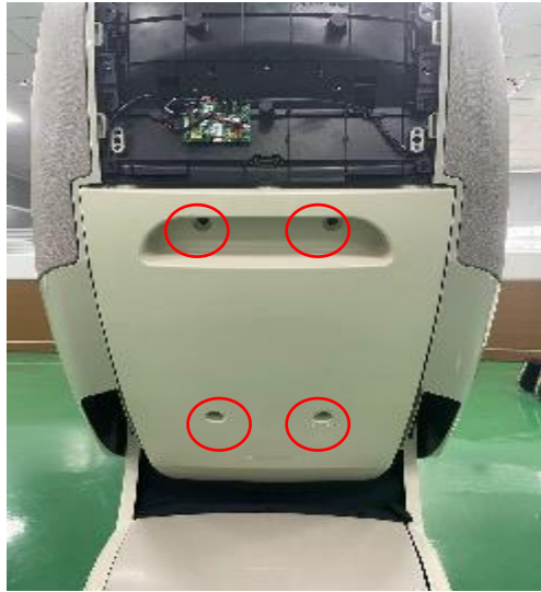
A. remove 4 screws
