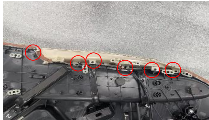
E. remove 6 screws
