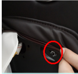
拆除 2 个固定螺母 Loose and screw 2 nut
