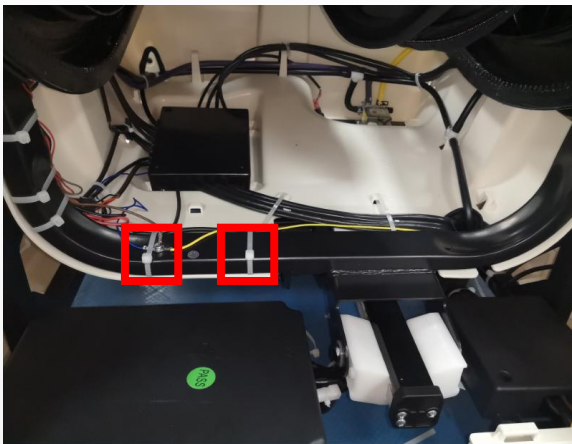
A.cut cable tie,disconnect the terminal
