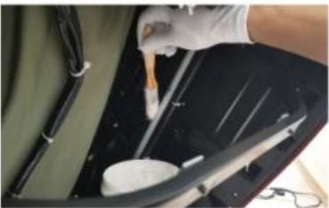
10、靠背导轨打固态润滑油
