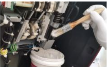
11、伸缩机构打固态润滑油
